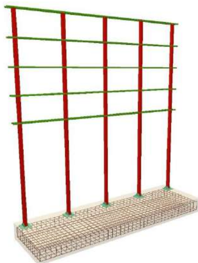
Figura 8: Vista 3D del cartel informativo y cimentación correspondiente
